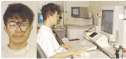
図 10 アイカメラ Fig. 10 Eye tracker.
