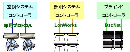
図 1 従来のビル管理システム実現方式
